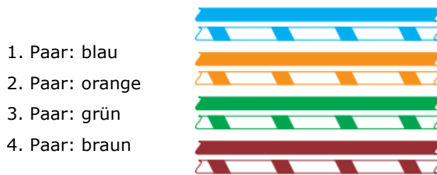
Abbildung 4: Farbcode und Zählweise eines Netzwerk-Kabels (EIA/TIA-568B)
